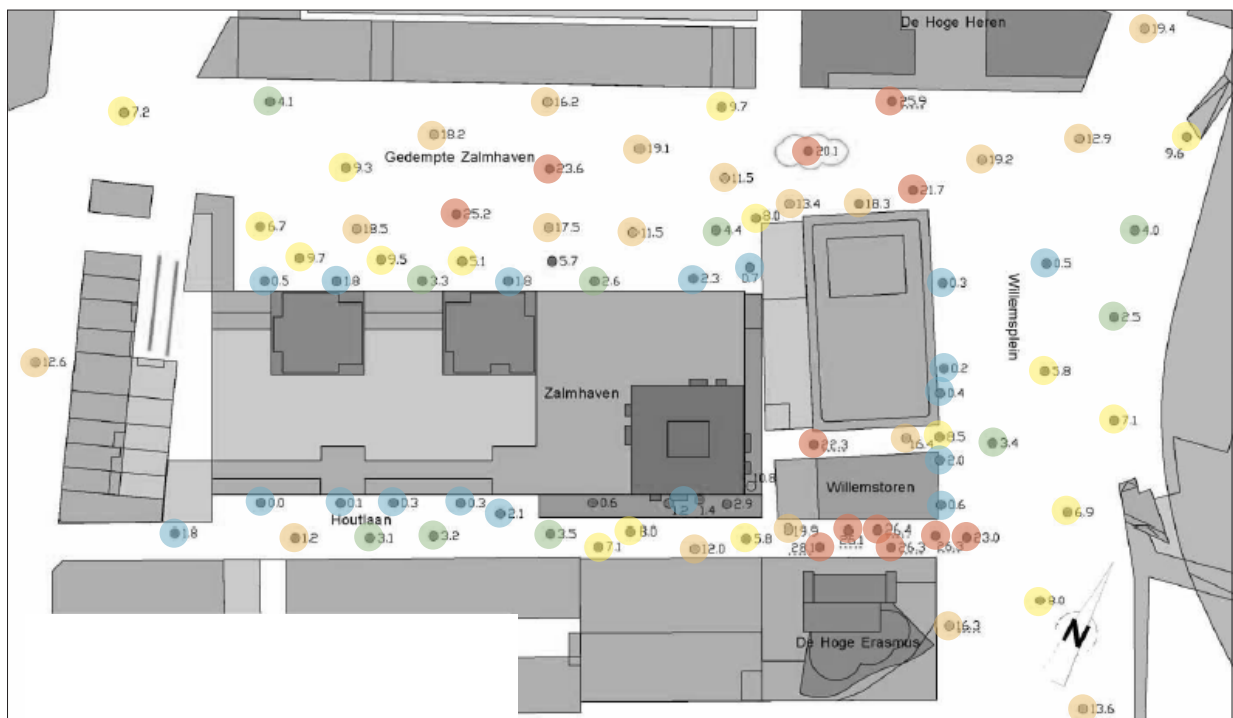
Resultaat windhinder windtunnelstudie, gebouwde situatie Zalmhaventoren, Centrum, door Peutz, 2015
